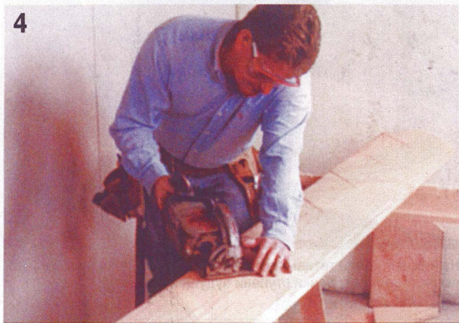
Начало каждого пропила делают дисковой пилой, не выходя за линии разметки.
