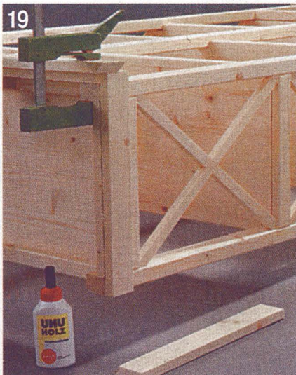
19 Планки второго слоя также зашлифовывают на ус.
