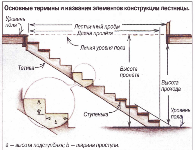
На нижнем конце тетивы из высоты первой ступени необходимо вычесть толщину доски ступени будущей лестницы.
