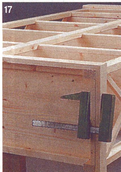
17 Прежде чем приклеивать планки декоративного карниза, их зашлифовывают на ус.
